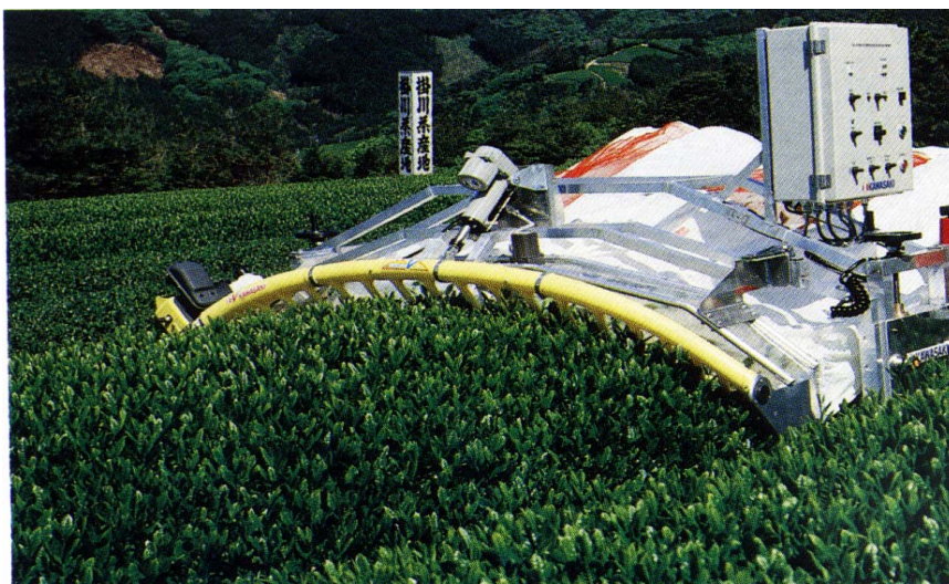
شکل ۱-۱۴- برداشت مکانیزه با ماشین برگ‌چین اپراتوردار
